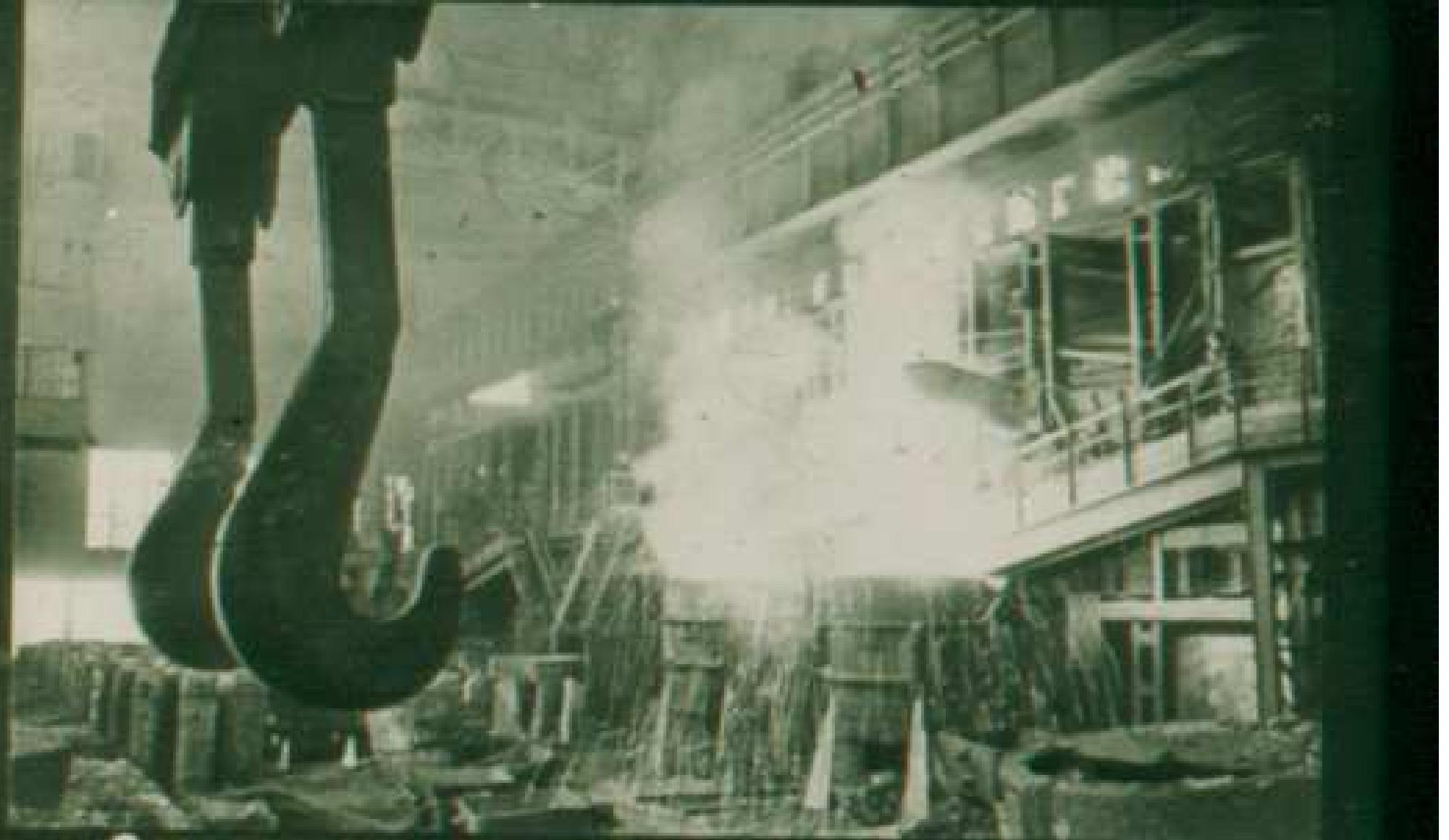
Ослепителен золотой водопад стали, брызгущий дождём искр. Краны нацелились подхватить наполненные сталью новши для разлива её в изложницы.
