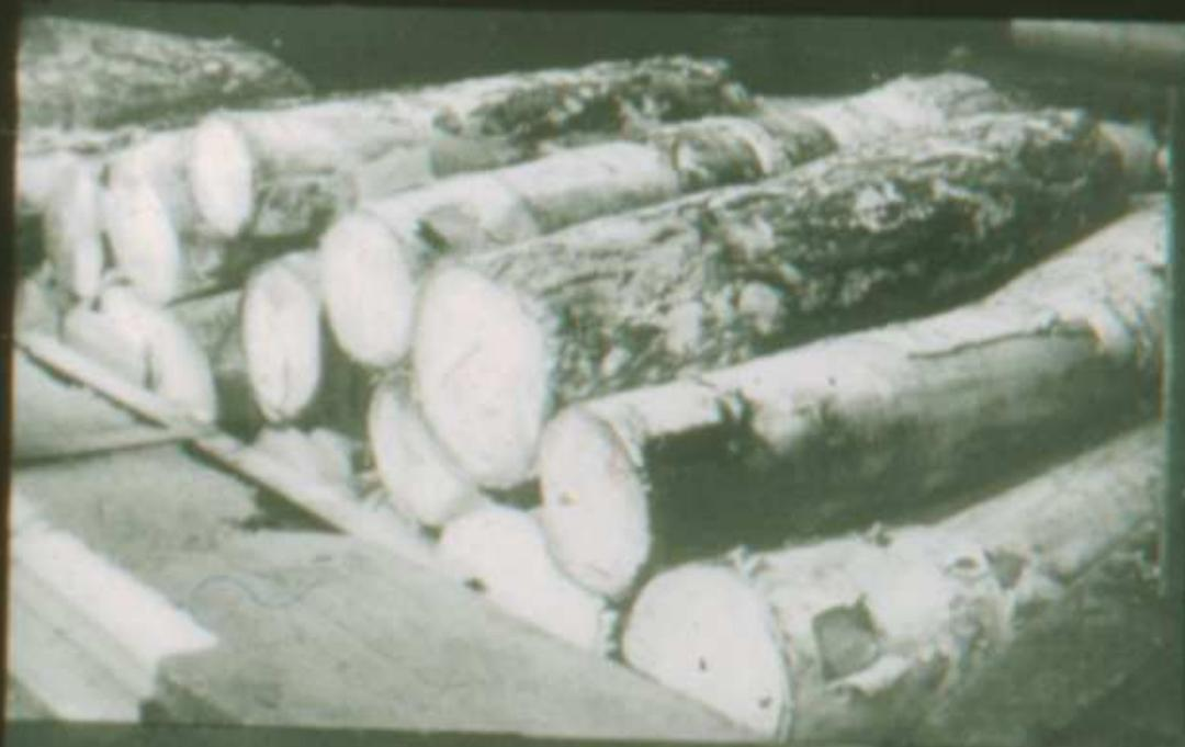
**Чтобы получить шпон, берут короткие брёвна, распаривают в горячей воде, потом подают в машину.**
